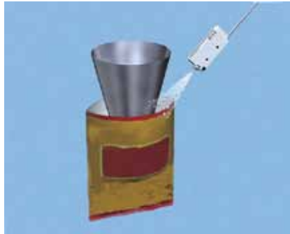
Beseitigung statischer Energie auf Verpackungsfolien
