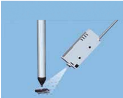
Abbau statischer Elektrizität an einem Mikrochip
