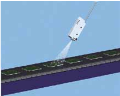
Abbau statischer Elektrizität auf Leiterplatten
