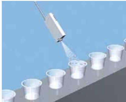
Abbau statischer Elektrizität von Kunststoffassen
