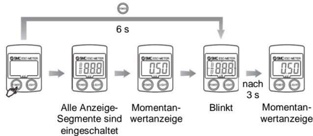
Wenn das Manometer erneut ausgeschaltet wird, wird das verzögerte automatische Abschalten zurückgesetzt.
