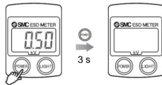
Zur Erhaltung der Batteriehaltbarkeit des Manometer nach der Verwendung ausschalten.
