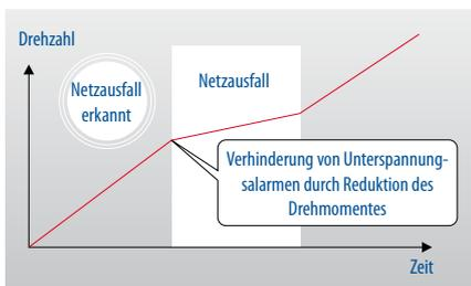
Das Auftreten von Unterspannungsalarmen wird wirkungsvoll verringert, indem das Drehmoment reduziert wird, sobald ein Netzausfall im Hauptstromkreis erkannt wird.
