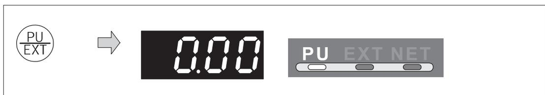
Wird die Taste PU/EXT beim „Betrieb über die Bedieneinheit“ betätigt, wird zur Steuerung durch externe Signale umgeschaltet. In diesem Fall leuchtet die Anzeige „EXT“.
