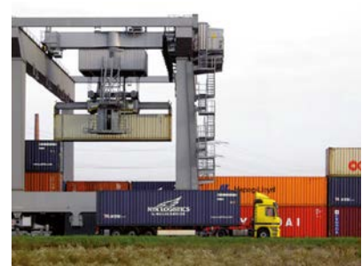
Schwebende Lasten lassen sich durch einen Motor und Encoder-Feedback exakt positionieren.
