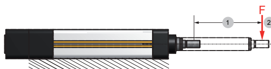
1: ausgefahrene Länge 2: Krafteinleitung - mittig Kolbenstangengewinde
