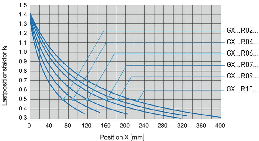
Die zulässige Radiallast kann durch Multiplizieren der zulässigen mittig angreifenden Radiallast mit dem Lastpositionsfaktor aus dem linken Diagramm ermittelt werden.
