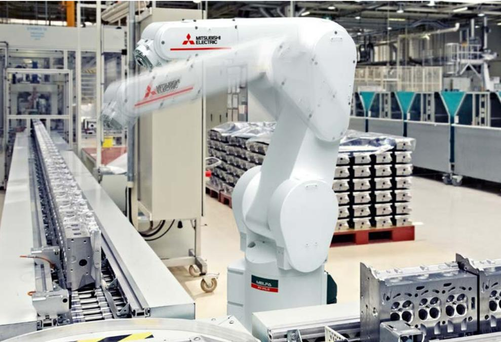
Die Einsatzmöglichkeiten der sensorgeführten Roboter in der Fabrikautomatation sind vielfältig. Sie reichen von der Bauteilmontage über die Qualitätskontrolle und Werkstücknachbearbeitung bis hin zur Objektllokalisierung und -entnahme von einem Förderband.
