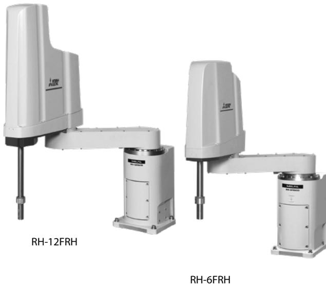
**Die SCARA-Roboter RH-FRH**
