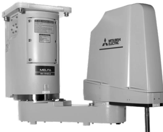
**SCARA-Roboter für Überkopfmontage**
