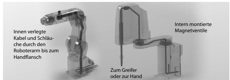
**Flexibilität durch interne Ethernet-Kabelanschlüsse**
