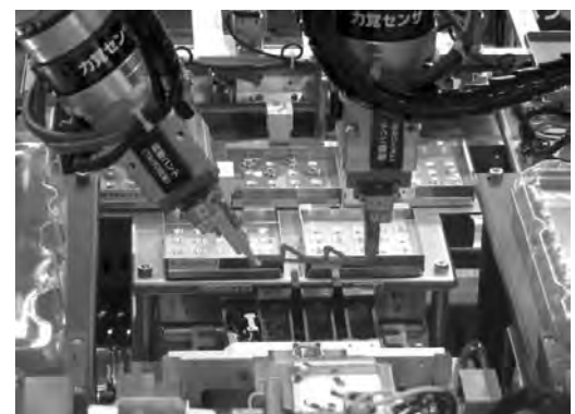
Die relativen Positionen der Handgreifer zueinander bleiben während des gesamten Installationsvorgangs unverändert.
