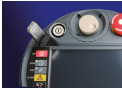
Einfache Zugänglichkeit des USB-Anschlusses
