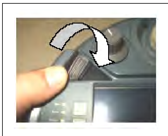
Abb. 6-2: Schutzabdeckung des integrierten USB-Anschlusses am Bediengerät R56TB öffnen
