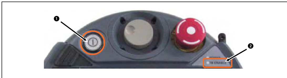
Abb. 8-2: Anordnung des TEACH-Tasters (❶) und der LED „TB ENABLE“ (❷) am Bediengerät
