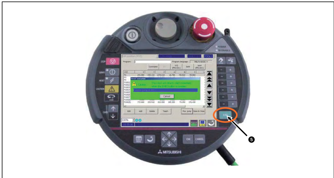
Abb. 7-76: Zum Start muss die EXE-Taste (⑤) betätigt werden.
