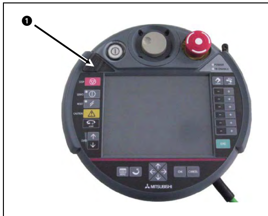
Abb. 6-1: Position des integrierten USB-Anschlusses am Bediengerät R56TB (1)
