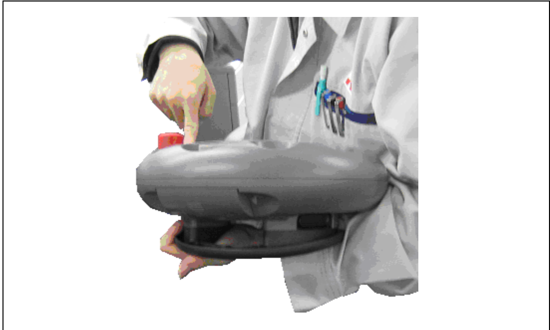
Abb. 4-1: Bediengerät auf dem Arm liegend festhalten und Zustimmungstaster betätigen
