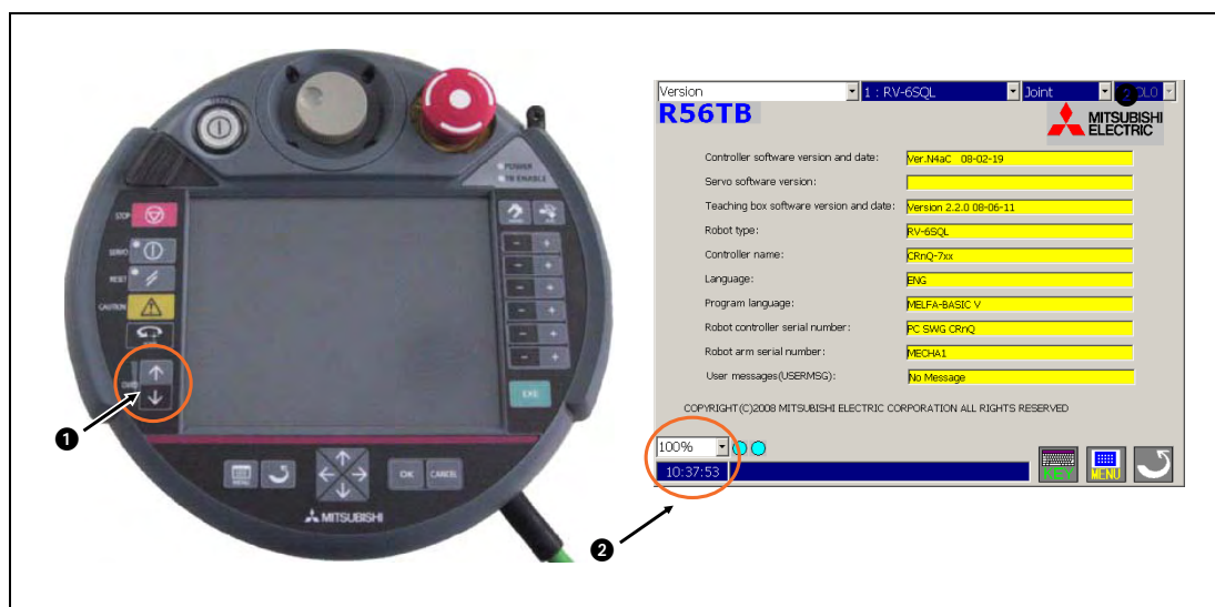
Abb. 5-1: Positionen der [OVRD ↑]- und [OVRD ↓]-Tasten (1) am Bediengerät und Position des Aufklappmenüs „Aktuelle JOG-Geschwindigkeit“ (2) im Hauptmenü auf dem Touchscreen des Bediengeräts
