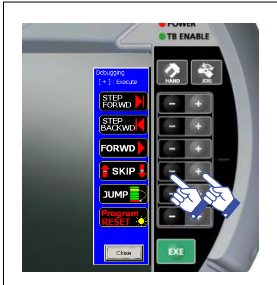
Abb. 8-3: SKIP-Funktion zum Überspringen von Programmzeilen
