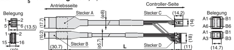
**LE-CP- $\frac{8}{AC}$**  / Kabellänge: 8, 10, 15, 20 m (\* Fertigung auf Bestellung)
