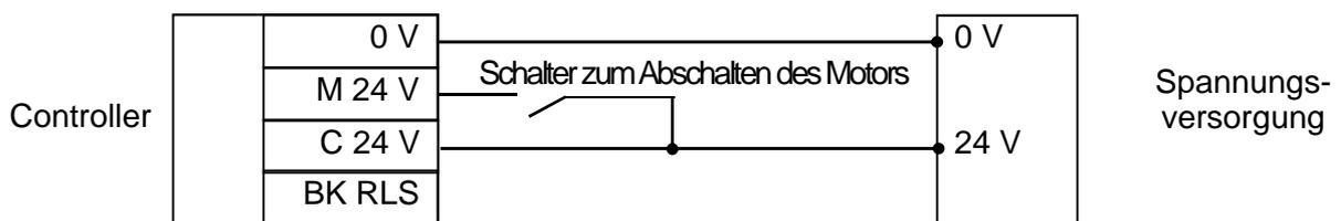
Der Antrieb stoppt, wenn M 24 V ausgeschaltet wird. Wenn M 24 V während des Betriebs des Antriebs ausgeschaltet wird, wird ein Alarm erzeugt.
