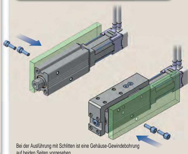
Bei der Ausführung mit Schlitten ist eine Gehäuse-Gewindebohrung auf beiden Seiten vorgesehen.
