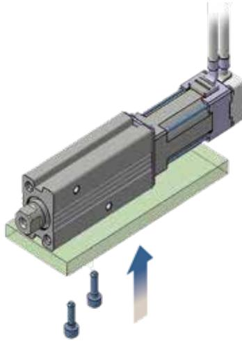
Axiale Montage nur Ausführung mit Kolbenstange (Gewindebohrung)
