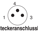
Steckeranschlussbild ventilseitig (für WA-Ausführung)
