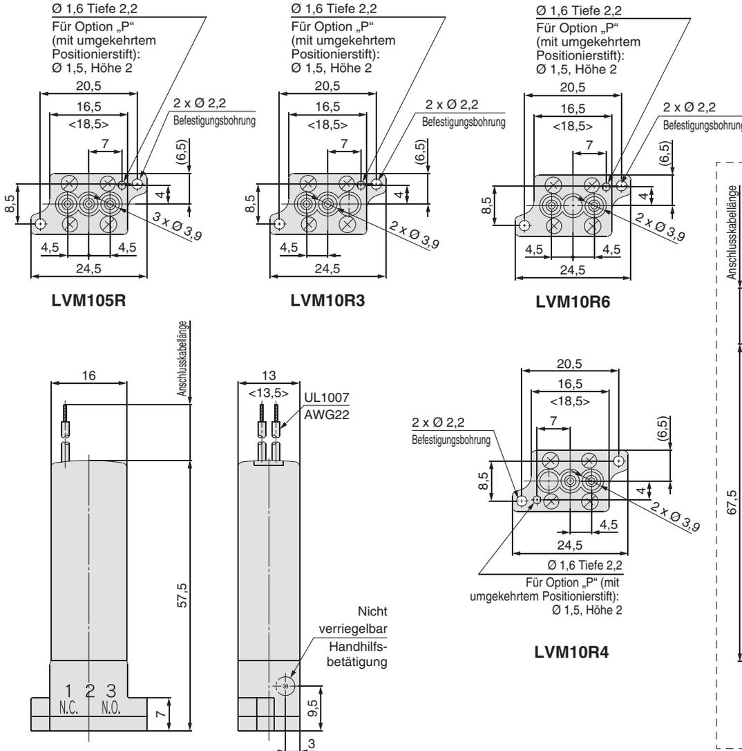
\* Die Angaben in  $\langle \rangle$  stehen für die Werte, wenn PFA als Plattenmaterial gewählt wird (Teile mit Medienkontakt „E“, „F“ oder „G“). Wenn PFA als Plattenmaterial gewählt wird (Teile mit Medienkontakt „E“, „F“ oder „G“), ist keine Positionierbohrung Ø 1,6 oder kein umgekehrter Positionierstift Ø 1,5 vorhanden.
