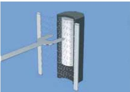
Abbau statischer Elektrizität beim Transport von Halbleiterscheiben
