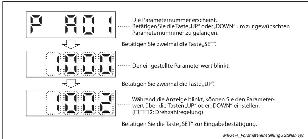
**Abb. 6-10:** Ändern von PA01 von „Lageregelung“ auf „Drehzahlregelung“
